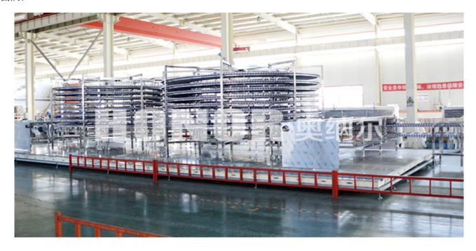
螺旋速冻机是一种结构紧凑、适用面广、占地面积小、冻结能力大的节能型快速冻结设备,是目前国内外 食品加工企业用于速冻肉类等冻品厚度大、体积大、进料温度高的机型。适用范围:调理食品、冰淇淋、面点、 分割肉禽、水产类、油炸类食品、小包装食品等。螺旋速冻机主要由传动部分、蒸发器、库板和电气装置构成; 传动部分由传动电机、网带、转塔和单独变频器组成;
